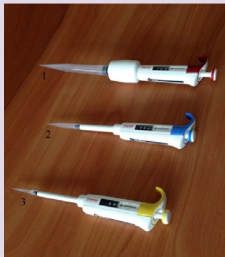
Рис. 7. Пипетки-дозаторы одноканальные переменного объёма: 1 — 1—10 мл; 2 — 100—1000 мкл; 3 — 10—100 мкл.
