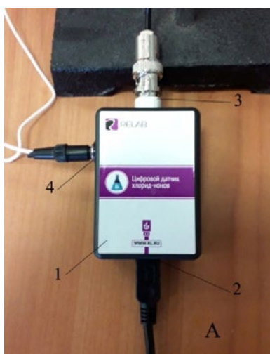
Рис. 3. Установка для определения концентрации (активности) хлорид-ионов в растворе. А: 1 — корпус датчика для определения \text{Cl}^- -ионов; 2 — разъём Micro USB для подключения к компьютеру; 3 — разъём BNC для подключения рабочего электрода; 4 — разъём для подключения электрода сравнения; Б: 1 — ионоселективный электрод (рабочий электрод); 2 — электрод сравнения (хлорсеребряный электрод); 3 — магнитная мешалка; 4 — якорь магнитной мешалки
